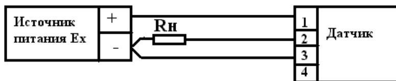
Рисунок А.1 – Схема соединений датчика с искробезопасным блоком питания
