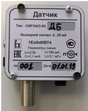
Датчик с термокаталитическим сенсором в силициновом корпусе
