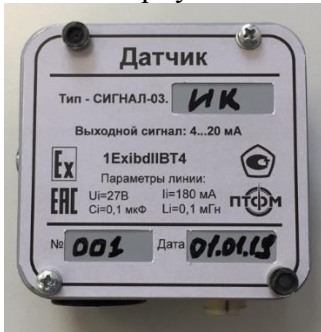
Датчик с ИК-сенсором в силициновом корпусе
