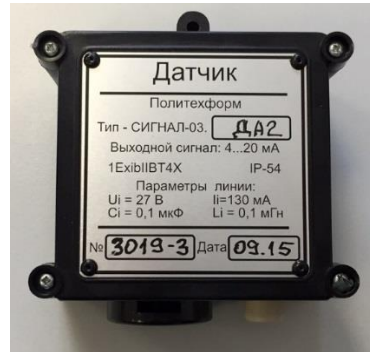
Датчик с электрохимическим сенсором в пластиковом корпусе
