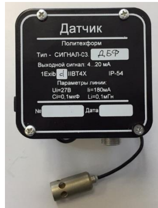
Датчик фланцевый с полупроводниковым сенсором в силициновом корпусе
