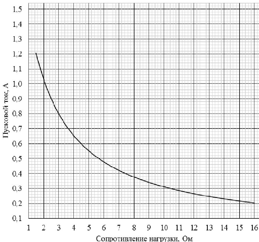
Рисунок 1 – График зависимости пускового тока от сопротивления нагрузки
