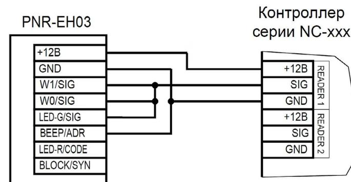
Рисунок 9. Подключение считывателя по интерфейсу Parsec, адрес 0 (наружный)
