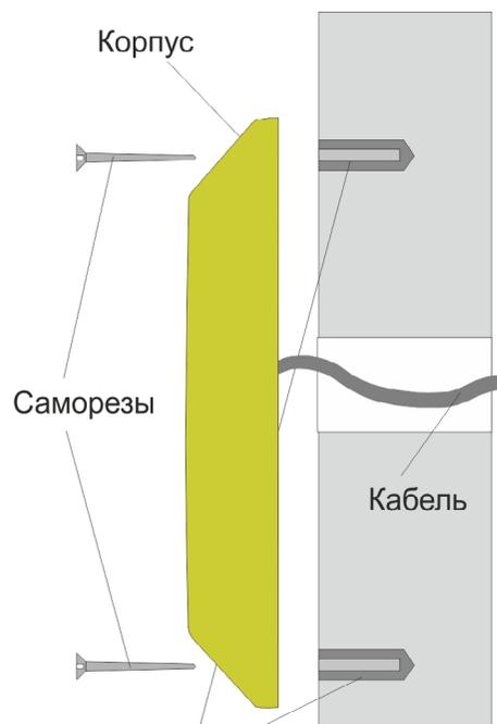
Рисунок 2. Крепление считывателя
