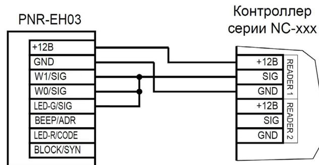
Рисунок 8. Подключение считывателя по интерфейсу Parsec, адрес 1 (внутренний)
