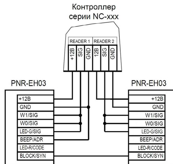
Рисунок 3. Режим синхронизации двух считывателей
