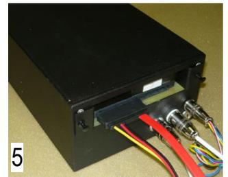
1. Закрепите направляющие диска на носителе винтами. Вытяните защелки дисков на себя (от носителя)
