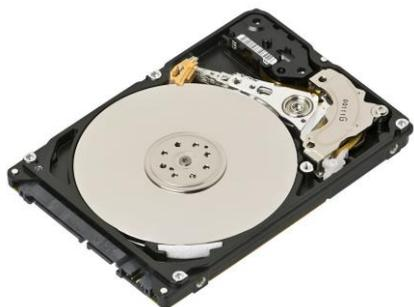
Жесткий магнитный диск - носитель данных в виде тонкого диска из немагнитного материала (обычно из алюминия, стекла или керамики), покрытого с одной или двух сторон слоем ферромагнетика. Это вещество, способное намагничиваться, то есть под воздействием внешнего магнитного поля изменять уровень остаточной намагниченности. Это свойство используется для записи единиц информации (упрощенно 1 – намагничено, 0 – размагничено) на поверхность диска при помощи магнитных головок. Вся конструкция
