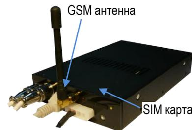
Контроллер устанавливается в зоне радиовидимости GSM сети, питание по интерфейсному кабелю.
