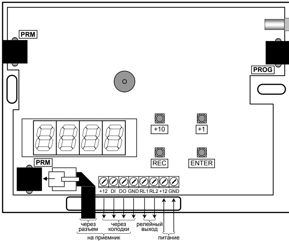
Рис. 4. Монтажная схема пульта при внутреннем подключении
