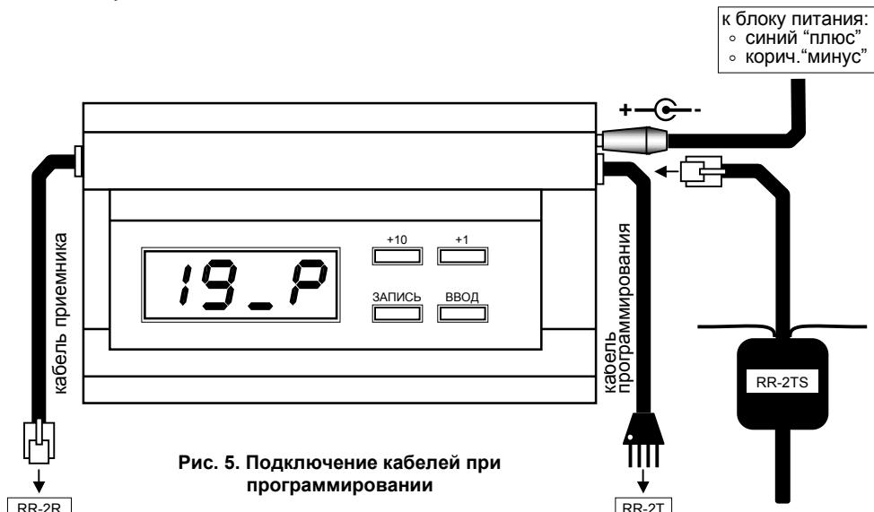
Рис. 5. Подключение кабелей при программировании
