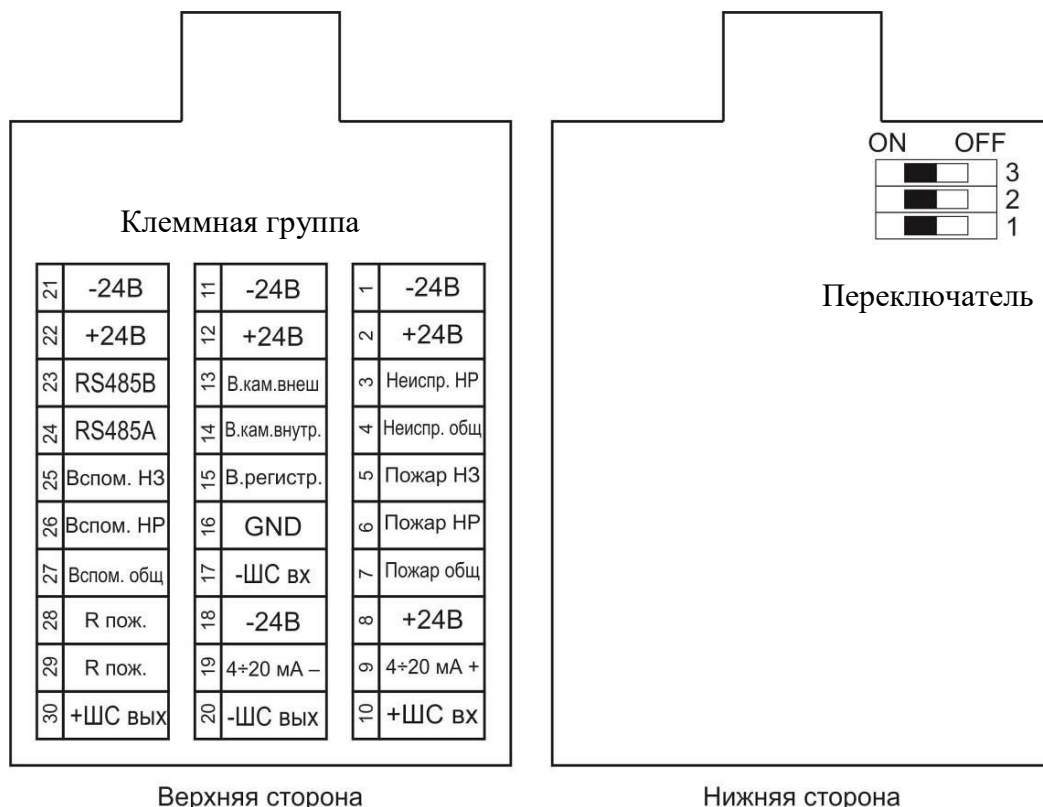
Рисунок 8 – Клеммная плата извещателя
