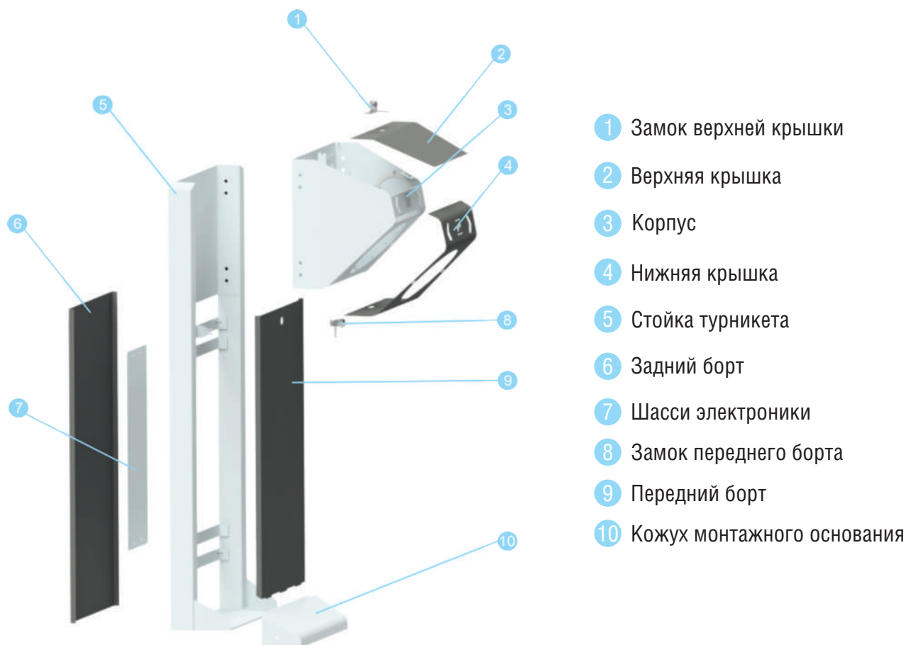
Рисунок 6.1.1. Устройство корпуса турникета
